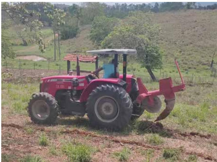
Trator com subsolador. Equipamento rompe a compactação do solo, favorecendo a infiltração da água da chuva
